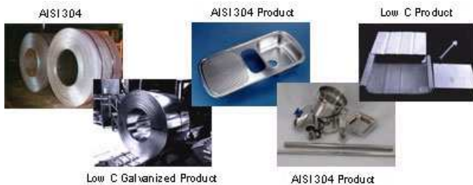
Figura nº 72. Productos obtenidos mediante tecnología de colada continua mediante solidificación rápida: aceros inoxidables AISI 304, aceros de bajo contenido en carbono, y aceros de bajo contenido en carbono galvanizados.
